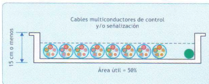
Fig. 16/5: Instalación de cables multiconductores de control y/o señalización.
