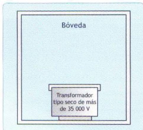
Fig. 10/10: Transformador tipo seco de más de 35 000 V.
