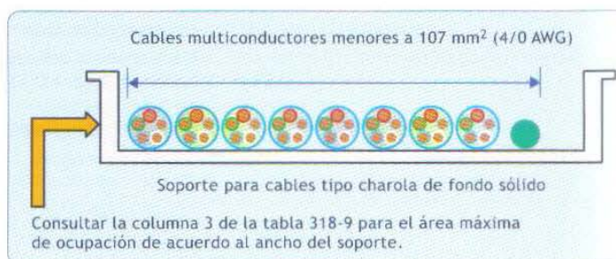
Fig. 18/5: Instalación de cables multiconductores menores al 107 mm 2 (4/0 AWG) en soporte para cables tipo charola de fondo sólido.
