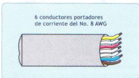
Fig. 18/4: Ejemplo con 6 conductores portadores de corriente.
